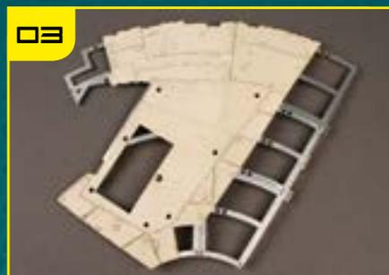
03 Монтаж фрагмента обшивки 11 из выпуска № 11. Прямоугольный вырез предназначен для одной из посадочных опор (опционально).
